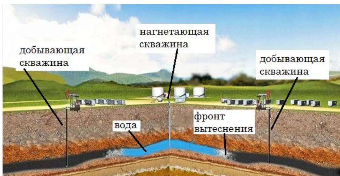
Рис. 19. Технология нефтедобычи: вытеснение нефти водой.
