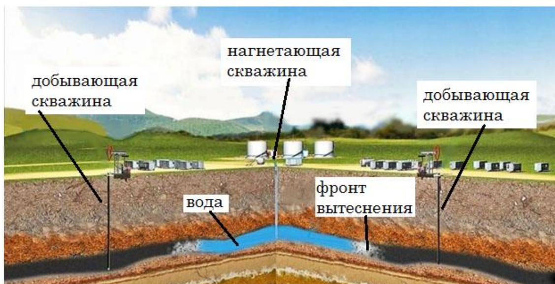
Рис. 19. Технология нефтедобычи: вытеснение нефти водой.
