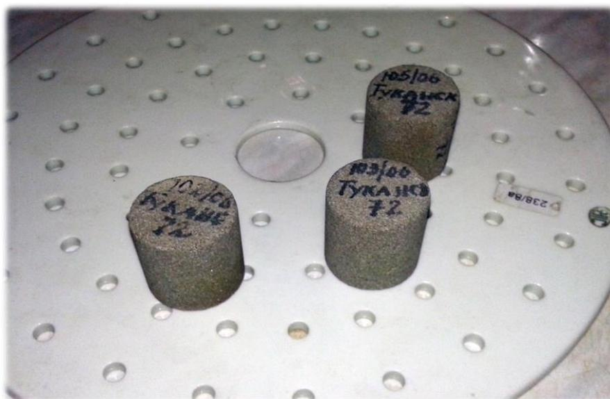
**Рис. 28. Составной образец керна.**
