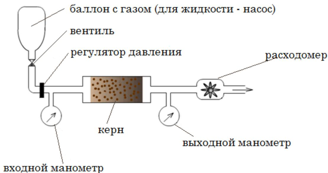
Рис. 16. Установка для изучения процесса фильтрации в керновом материале.
