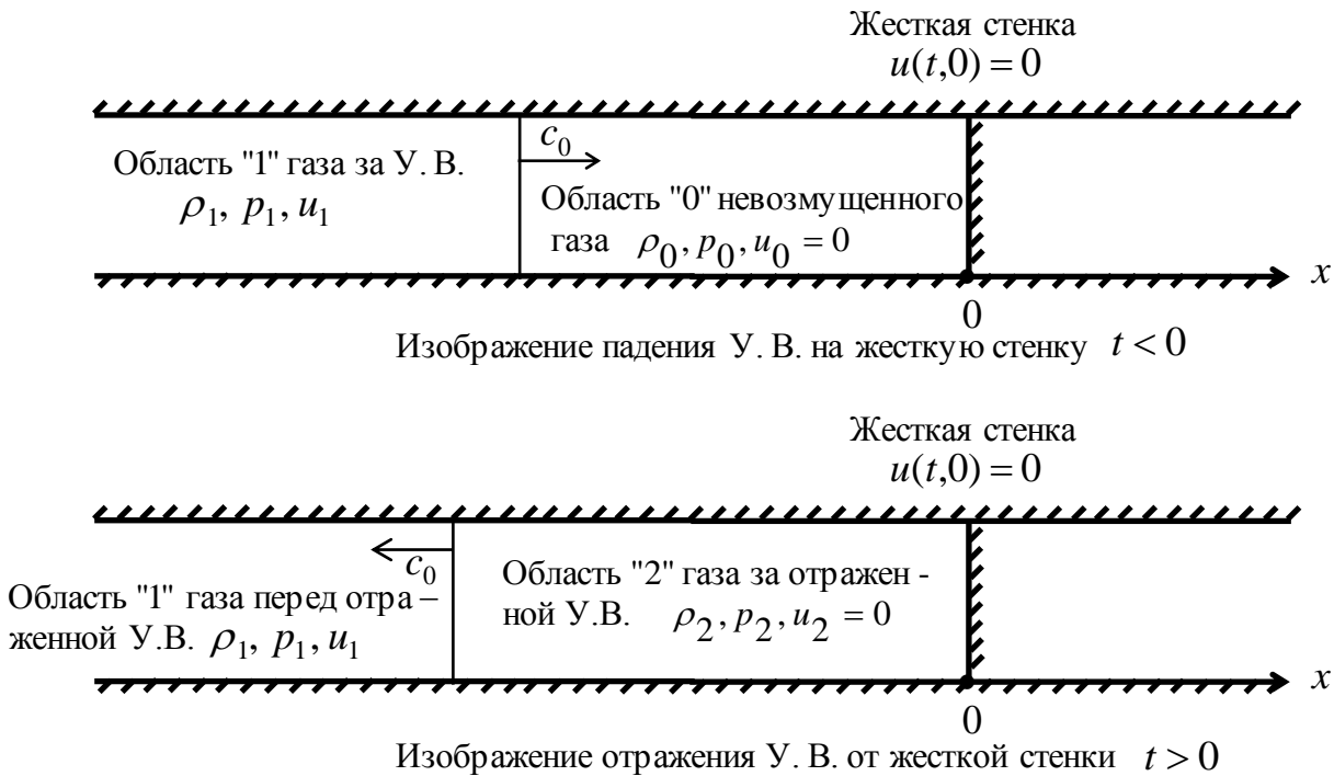
Рис. 3.11 Картина отражения У. В. от жесткой стенки в физической плоскости
